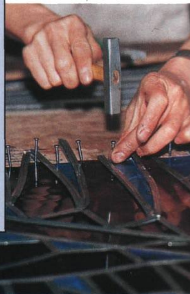
В свинцовые каркасы, обрамляющие каждый кусочек стекла в витражном окне, забиваются гвозди.
